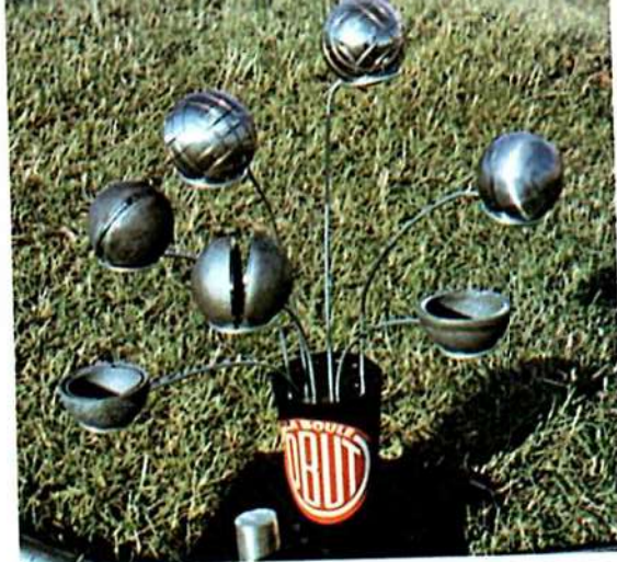
Ci-dessus, on voit les principales étapes franchies par une boule au cours de sa fabrication (lopin - coquille - coquilles soudées - boule tournée, striée, chromée)
